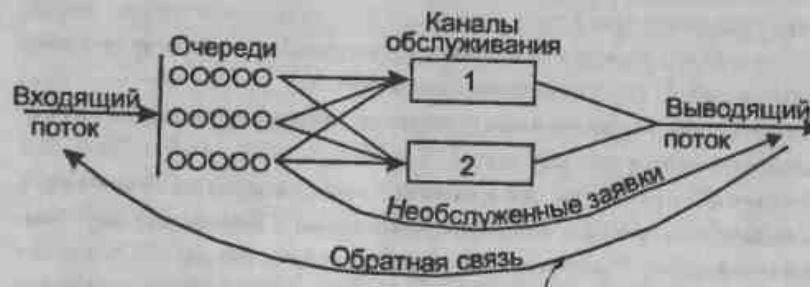
Рис. 1.1. Схема системы массового обслуживания
