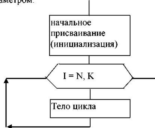
Рис.4. Функциональная схема арифметического цикла с известным числом повторений.
